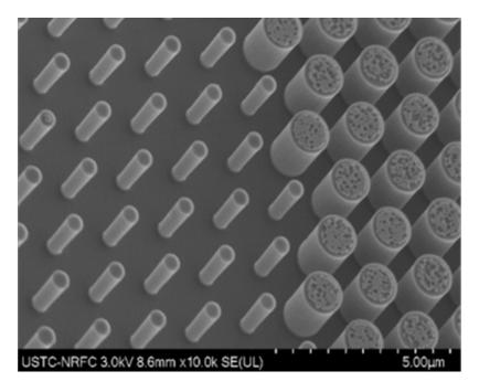
刻蚀工艺:把未被抗蚀剂掩蔽的薄膜层除去,从而在薄膜上得到与抗蚀剂膜上完全相同图形的工艺。在集成电路制造过程中,经过掩模套准、曝光和显影,在抗蚀剂膜上复印出所需的图形,或者用电子束直接描绘在抗蚀剂膜上产生图形,然后把此图形精确地转移到抗蚀剂下面的介质薄膜(如氧化硅、氮化硅、多晶硅)或金属薄膜(如铝及其合金)上去,制造出所需的薄层图案。刻蚀就是用化学的、物理的或同时使用化学和物理的方法,有选择地把没有被抗蚀剂掩蔽的那一部分薄膜层除去,从而在薄膜上得到和抗蚀剂膜上完全一致的图形。刻蚀技术主要分为干法刻蚀与湿法刻蚀。干法刻蚀主要利用反应气体与等离子体进行刻蚀;湿法刻蚀主要是利用化学试剂与被刻蚀材料发生化学反应进行刻蚀。中山硅材料刻蚀加工工厂刻蚀就是用化学的、物理的或同时使用化学和物理的方法,有选择地把没有被抗蚀剂掩蔽的那一部分薄膜层除去。
